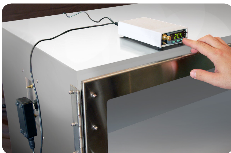
ProOx P110氧气控制器通过不锈钢适配板连接在动物笼A-Chambers。
