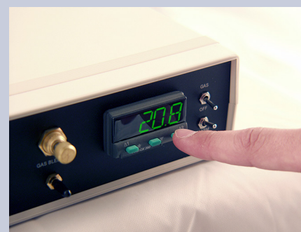
ProOx P360很容易通过其前面板进行操作。数字输出显示当前的氧含量，不使用时进行预设。
