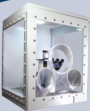
任何第三方细胞设备都可以放置其中，包括显微镜（如上所示）、离心机、细胞分类器、制冷器等。
