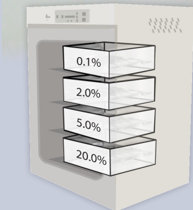
多个ProOx P110s可以独立控制同一个大培养箱内的不同培养chamber，是替代普通三气培养箱的经济型方案。
