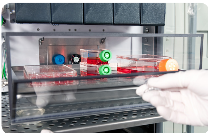
适配板可以将细胞与适配腔里的探头隔离开，以防污染。
