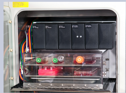
多个适配器安装不同探头的设计，可以显著减少例行维修。
