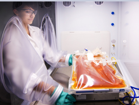
具有温度、O2、CO2控制系统的X3处理室可以用于无需RH控制的特定培养用途。
