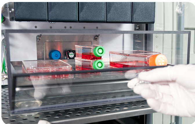
La piastra di adattamento separa le cellule dai sensori nei pod creando una barriera antimicrobica.
