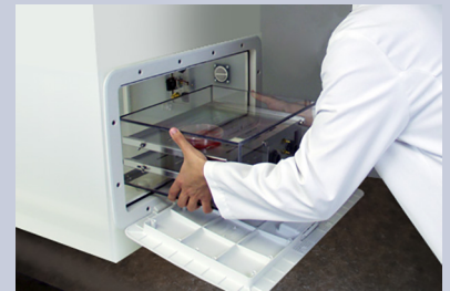
細胞が安全にかつ酸素およびCO 2 の濃度を変えずに移動することが可能です。搬送チャンバーに入れば、Xvivoシステムの外を移動することができます。
