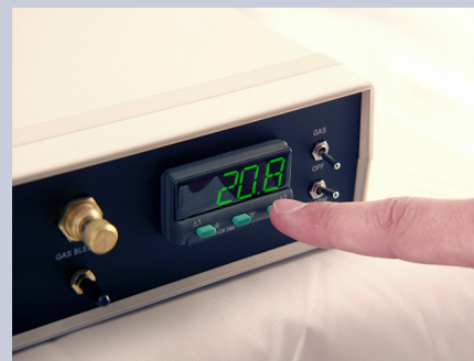
ProOx P360はフロントパネルインタフェースを介して簡単に操作することが出来ます。チューニング等操作時以外は、実際の酸素濃度をデジタルで表示します。
