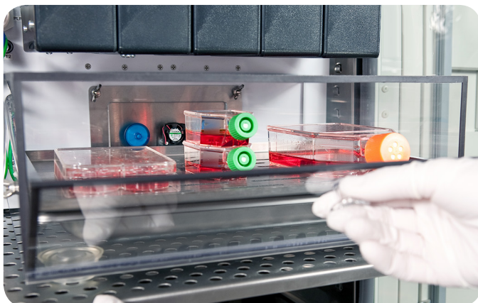
A placa de adaptador separa as células de sensores com barreiras antimicrobianas.
